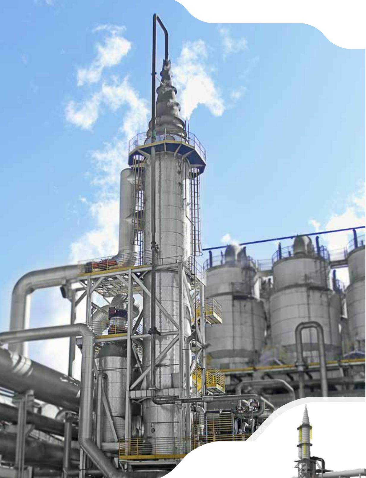
Pré-Evaporador ENET® com capacidade de 400 m<sup>3</sup>/h de alimentação
